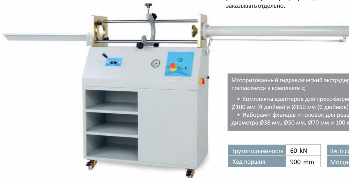
Моторизованный гидравлический экструдер UTGE-0084 горизонтального типа предназначен для вытеснения образцов диаметром от 50 мм (2 дюйма) до 125 мм (5 дюймов) (наружный диаметр) из пробирок и пресс-форм shelby, таких как формы proctor, CBR и marshall, а также для отбора проб и удаления одноосных и трехосных испытательных образцов в/из резцов внутреннего диаметра от 38 мм до 100 мм.
