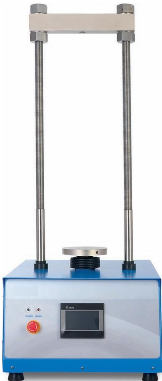
Мультиплексная машина используется для проведения одноосных, CBR и маршалловских испытаний. Мультиплексная машина мощностью 50 кН оснащена серводвигателем и системой управления жидкокристаллической графикой и способна выполнять испытания в диапазоне скоростей от 0,00001 мм/мин до 51 мм/мин, пригодных для испытаний CBR, Marshall, трехосных и одноосных испытаний.
