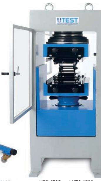
Испытательные рамы ASTM & AASHTO на сжатие для блоков и цилиндров состоят из жестких сварных стальных стенок, узла нагрузочного цилиндра и нижних и верхних (сферически расположенных) опорных пластин.
