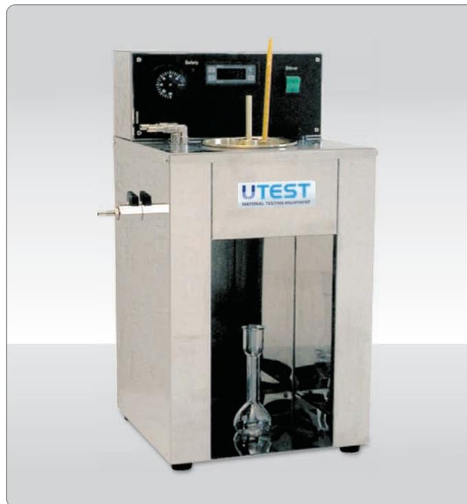
Цифровой вискозиметр Энглера UTB-1250 используется для определения вязкости битума и его жидких продуктов. Устройство состоит из контактного терморегулятора и перемешивающего устройства.
