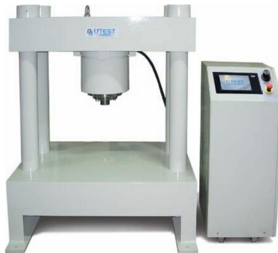
Испытательная машина UTSP-0350.FPR была разработана для проведения испытаний (испытание на постоянную установку, испытание на несущую способность) на крышах люков и водостоков в соответствии со стандартом EN 124-1.
