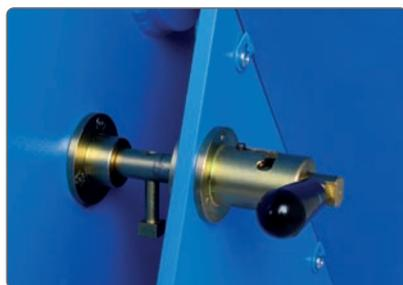
Блокировка положения барабана на с предохранительным выключателем
