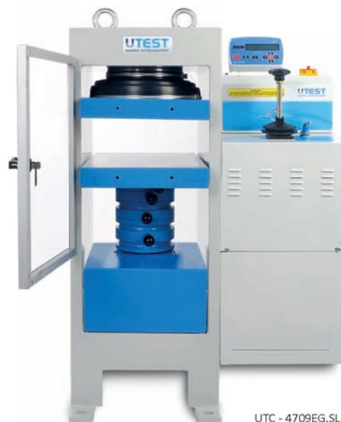
Модели UTC-4609 E. SLP и UTC-4709 E. SLP Полуавтоматические устройства для испытания на сжатие изготавливаются для испытания на сжатие кирпичных модулей/ блоков, цилиндров и кубов. Эти устройства также отвечают требованиям норм CE в отношении здоровья и безопасности оператора. А их удобный дизайн позволяет неопытному оператору выполнить испытание.
