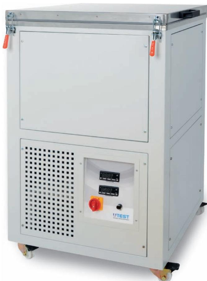
Испытания на сульфат магния и сульфат натрия используются для определения прочности заполнителей при воздействии на них таких воздействий, как замораживание и оттаивание в бетоне или других областях применения. Только конкретные продукты перечислены выше для теста. Следует отметить, что для проведения этих испытаний также требуется другое оборудование, такое как печи, сита, весы и т.д.
