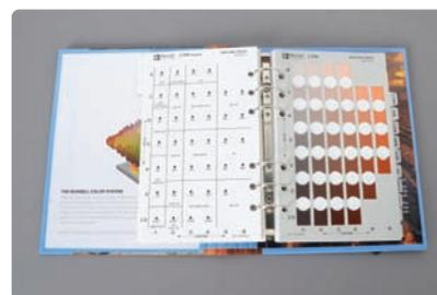
Карта почв Манселла UTS-0285 обеспечивает простой метод классификации почв путем определения цвета образцов почвы.
