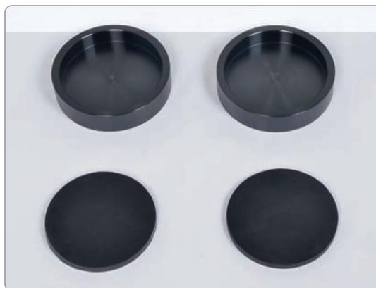
Неограниченный колпачок используется для определения прочности на сжатие затвердевших бетонных цилиндров в качестве альтернативного метода серой горячей укупорки образцов бетонных цилиндров. Накладки выравнивают неровности, равномерно распределяя испытательную нагрузку, чтобы обеспечить надежные результаты прочности. Накладки многоразовые для ограниченного числа испытаний в соответствии со стандартами
