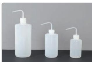
Промывалки лабораторной посуды
