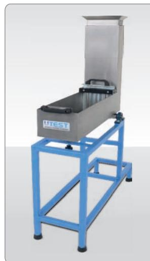
Коробка L-образной формы UTC-0545 применяется для определения коэффициента проходимости свежего смешанного самоуплотняющегося бетона. Расстояние между стержнями диаметром 12 мм может быть установлено в диапазоне 41±1 мм или 59±1 мм.
