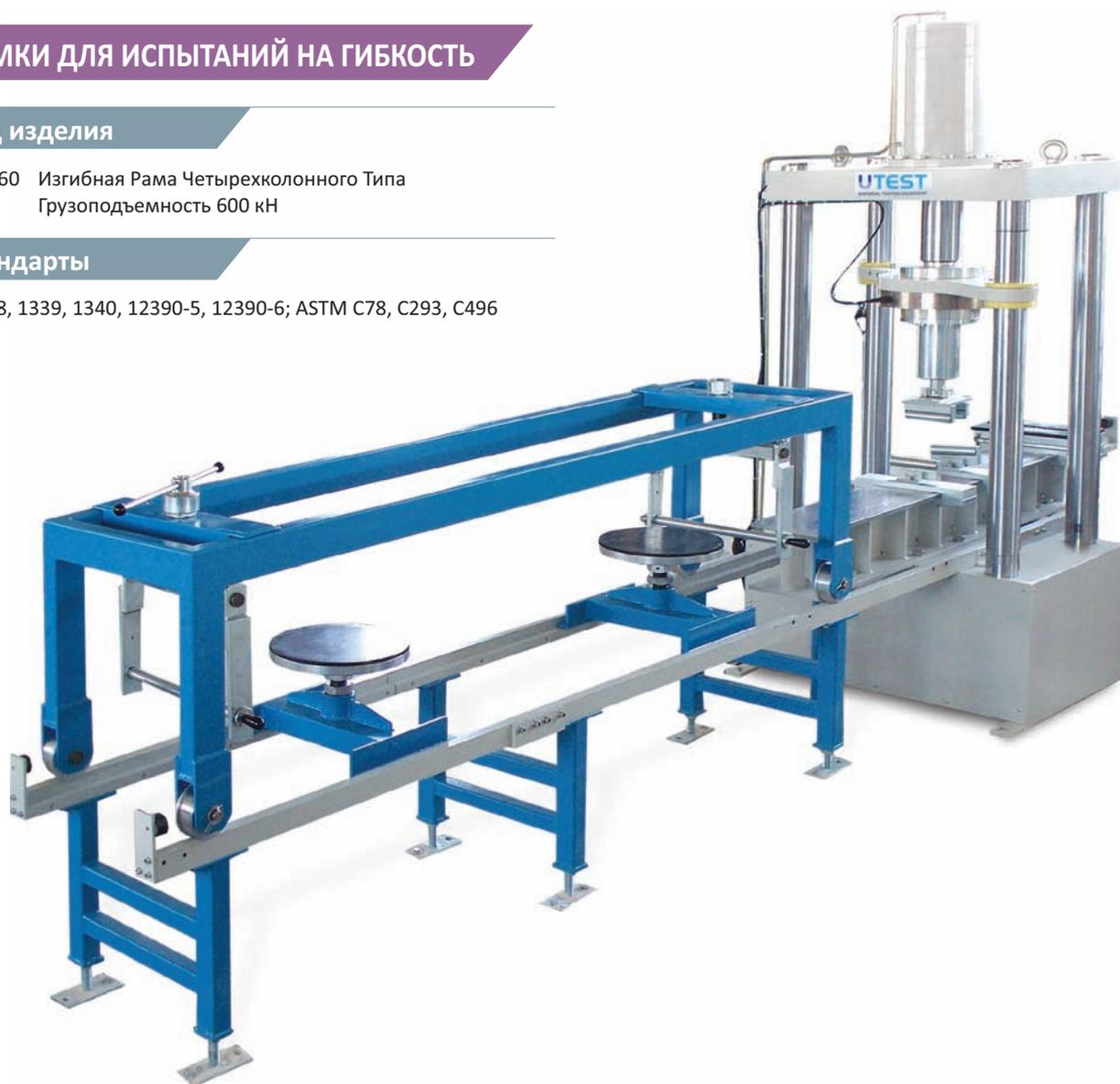
•Изгибная рама UTEST грузоподъемностью 600 кН рассчитана на минимальное отклонение при максимальной нагрузке, что обеспечивает очень высокую точность. Рама нагрузки представляет собой конструкцию из четырех колонн, несущего поршня, установленного на верхней перекладине. Рамки имеют двойной действующий поглаживающий поршень с защитой от переключения перемещения, чтобы выключить машину при достижении максимального перемещения поршня. Для измерения нагрузки на раму используется тензодатчик.
