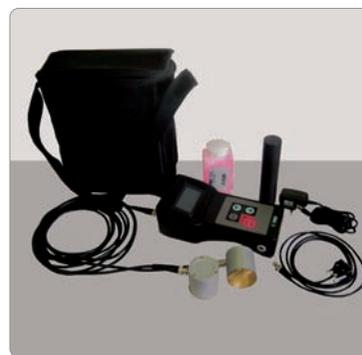
Ультразвуковой измеритель скорости импульсов поставляется в комплекте с;
