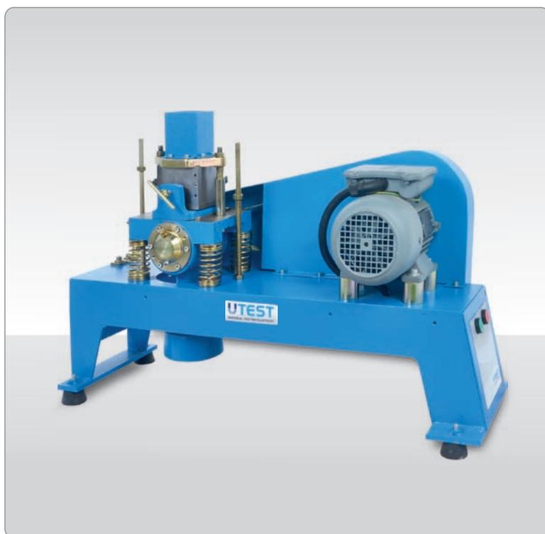
Вибрирующее устройство UTC-0930 используется для подготовки и уплотнения кубических образцов строительного раствора диаметром 70,7 мм. Стол пресс-формы установлен на четырех пружинах, прикрепленных к эксцентриковому валу, который позволяет вибрировать каждый образец со скоростью 12000 циклов в минуту. На нем есть таймер для установки времени, и он автоматически останавливается каждые 120 секунд.
