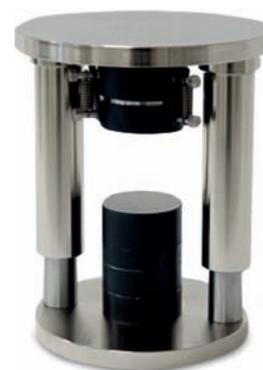
UTR-0426 предназначен для испытания на разрывную прочность образцов горных пород диаметром 54,7 мм и 63,5 мм и поставляется с дистанционным наконечником ASTM.
