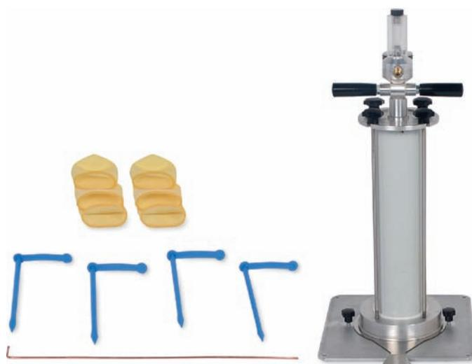
Устройство Баллона плотности используются для определения плотности хорошо связанной почвы на месте в соответствии с ASTM и французскими стандартами соответственно.
