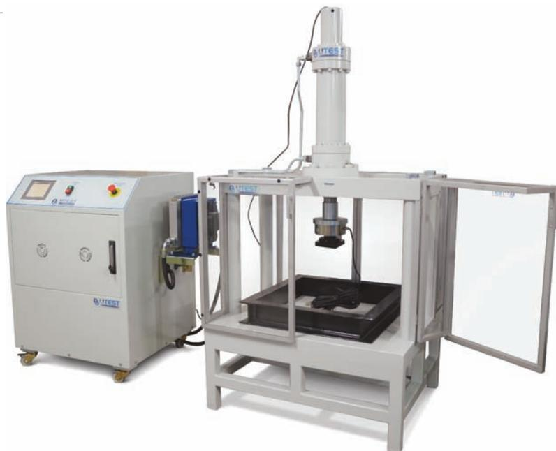
Универсальное Автоматическое Устройство Для Испытания На Изгиб с Сервоприводом специально сконфигурировано для испытаний на поглощающую способность энергии, а также для других испытаний образцов армированного волокном напыленного бетона.
