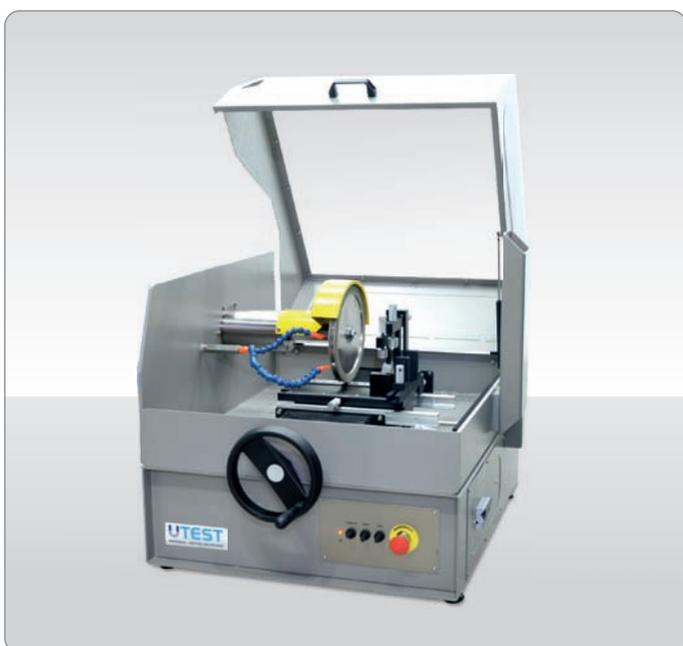
Лабораторный кернорез и отрезной станок UTR-0300 используется для получения образцов идеально обработанных образцов горных пород (кубики, призмы и т.д.) из нестандартных кусков породы или керна.
