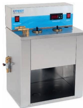
Вискозиметр Saybolt UTB-1300 используется для определения эмпирического измерения вязкости Saybolt нефтепродуктов при заданных температурах. Время, необходимое для того, чтобы образец объемом 60 мл прошел через пробирку с заданным диаметром (фурул или универсальный), измеряется и сообщается в секундах.
