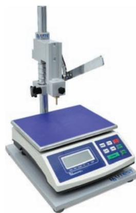
Устройство состоит из вертикального нагрузочного столба с основанием. Поставляется в комплекте с латунным проникающим стержнем с шайбой и контейнером для образцов (алюминий Ø80x80 мм).
